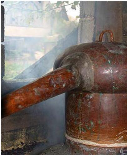
La forte source de chaleur dura environ 1h ou 1h30m. On pouvait presque voir la farine de seigle en train de sécher et de devenir dure. Il a parfaitement fonctionné car il n'y a eu aucune fuite de vapeurs entre les jointures.
