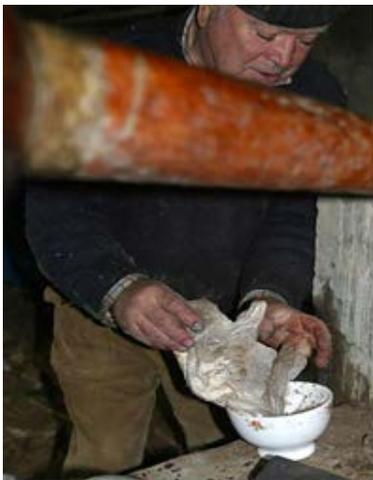
Mr. Leandro poursuit sa distillation en préparant une pâte à base de farine de seigle et d'eau avec laquelle il a scellé toutes les jointures entre le chapiteau et la chaudière.
