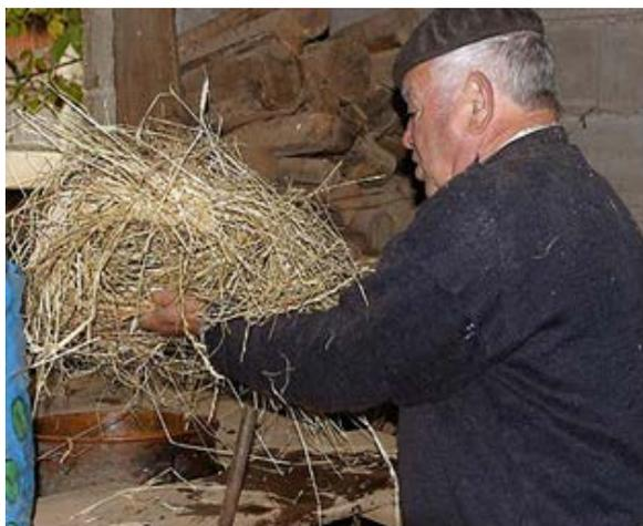
Il existe également de nombreux modèles d'alambics qui comprennent une plaque-tampon à moût, placée dans la base de la chaudière, qui permet d'éviter cet inconvénient. Mr. Leandro plaça la paille à l'intérieur de la chaudière où elle a été laissée en train de flotter dans l'eau.
