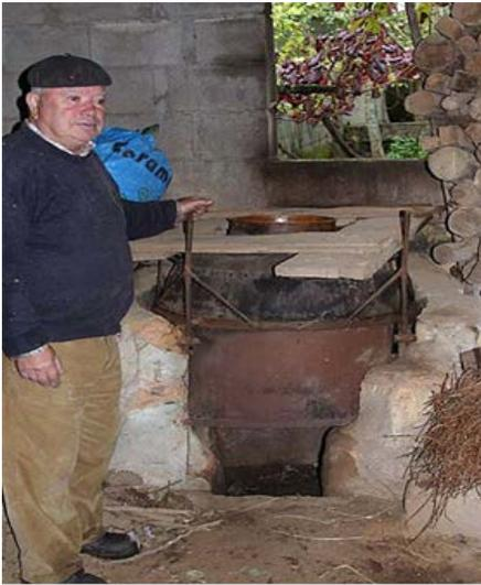
L'alambic de 150 litres était dans un petit local. La chaudière a été placée dans une superficie faite à base d'argile qui aide à garder la source de chaleur pour la distillation. La chaudière possédait également une structure métallique qui permettait d'aider à vider la chaudière et à la nettoyer à la fin de chaque distillation.
