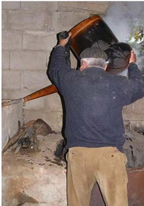
L'eau-de-vie était prête et il fallait commencer à tout nettoyer. Cette tâche est fondamentale pour maintenir le cuivre dans de bonnes conditions et pour augmenter sa longévité car si l'alambic n'est pas nettoyé, les acides chimiques produits pendant la distillation vont le détériorer.
